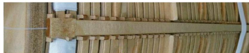
内置了传感器串的撑条在变压器内的安装
